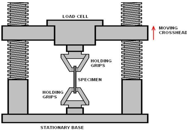
Fig. 1. Tensile Machine
