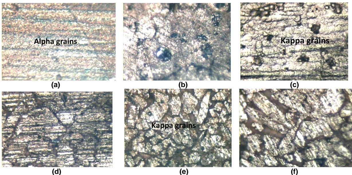
**Plate 1:** Aluminium-bronze morphologies with iron millscale at (a) 0% (b) 2 wt.% (c) 4 wt.% (d) 6 wt.% (e) 8 wt.% (f) 10 wt.%
